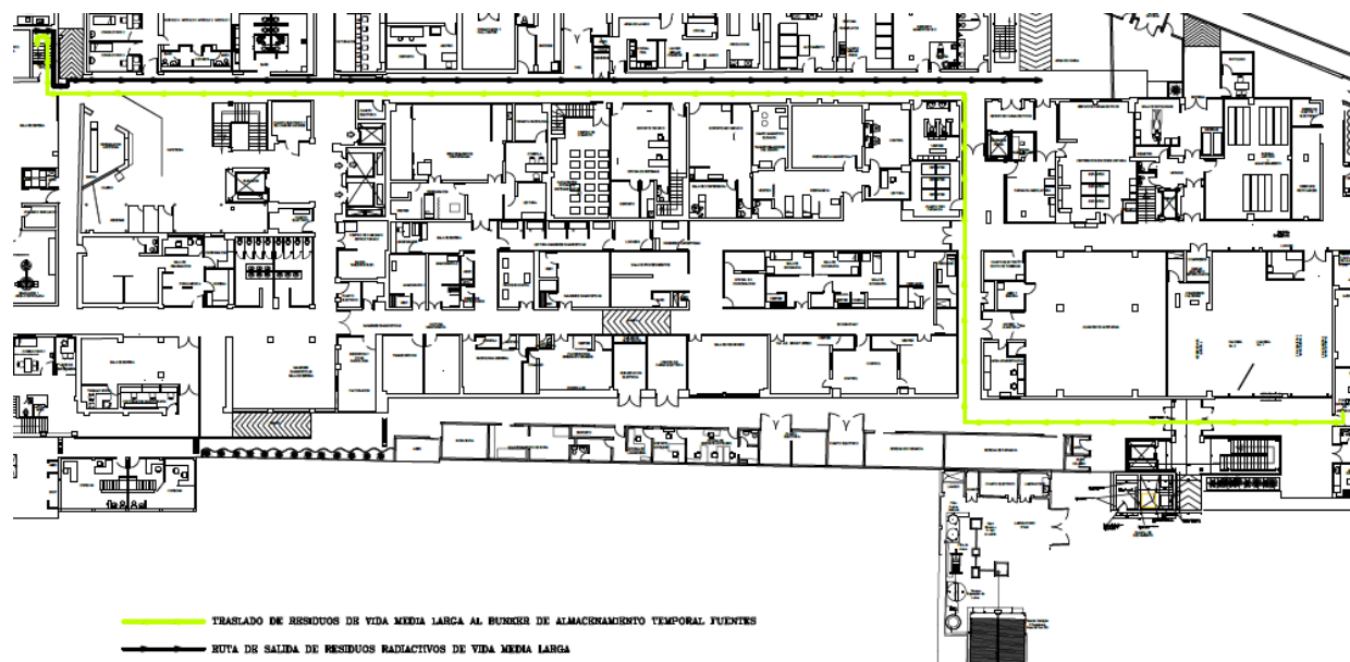
Figura 13 Transporte de fuentes en desuso al búnker
