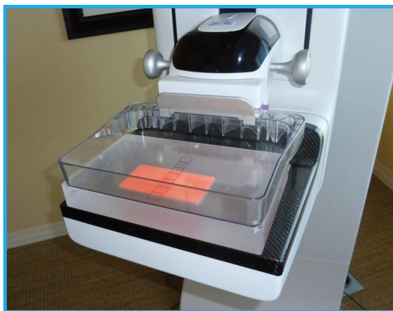
Figura 33. Posicionamiento del phantom MD de la ACR para la adquisición de imágenes en un sistema 2D.
