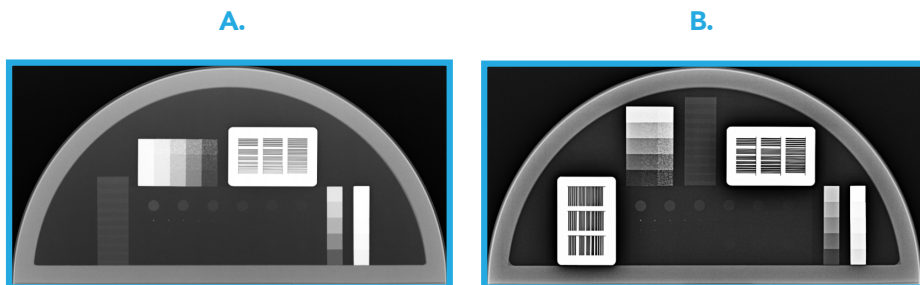
Figura 17. Imagen de rayos X del phantom de mamografía Leeds A. TORMAS y B. TORMAX.
