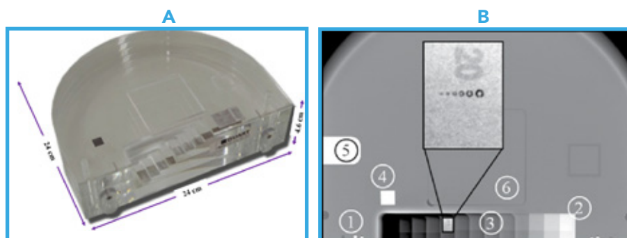
Figura 22. Phantom MAM/DIGI: a. imagen del phantom MAM/DIGI y b. Esquema del phantom MAM/DIGI, (1) son las bolas de acero para la alineación phantoms y la evaluación del tejido excluido de la imagen, (2) es la cuña escalonada con los anillos Landolt, (3) la cuña escalonada uniforme, (4) el cuadrado de latón para MTF, (5) una ranura para un dosímetro o detector y (6) una sección tallada para insertos adicionales opcionales.
