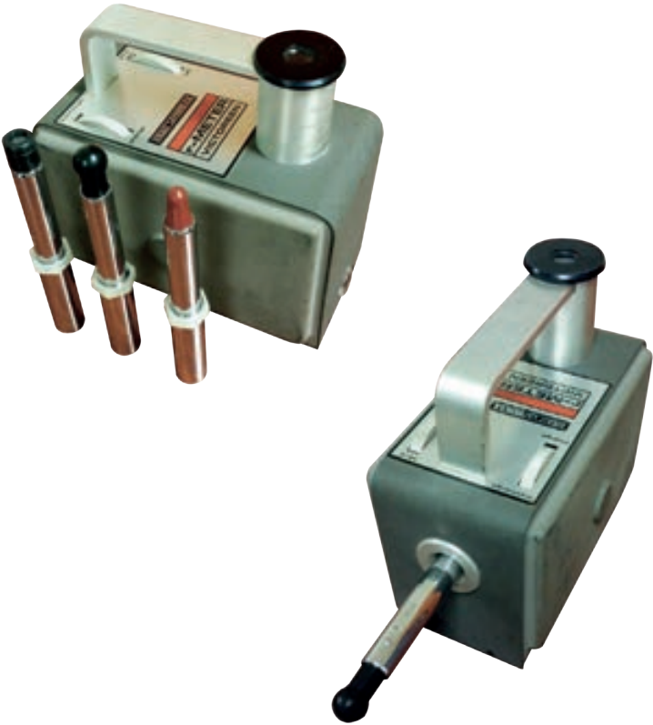
Equipos para medir la dosis de radiación en haces de fotones de radioterapia. Fotografía: Archivo INC.
